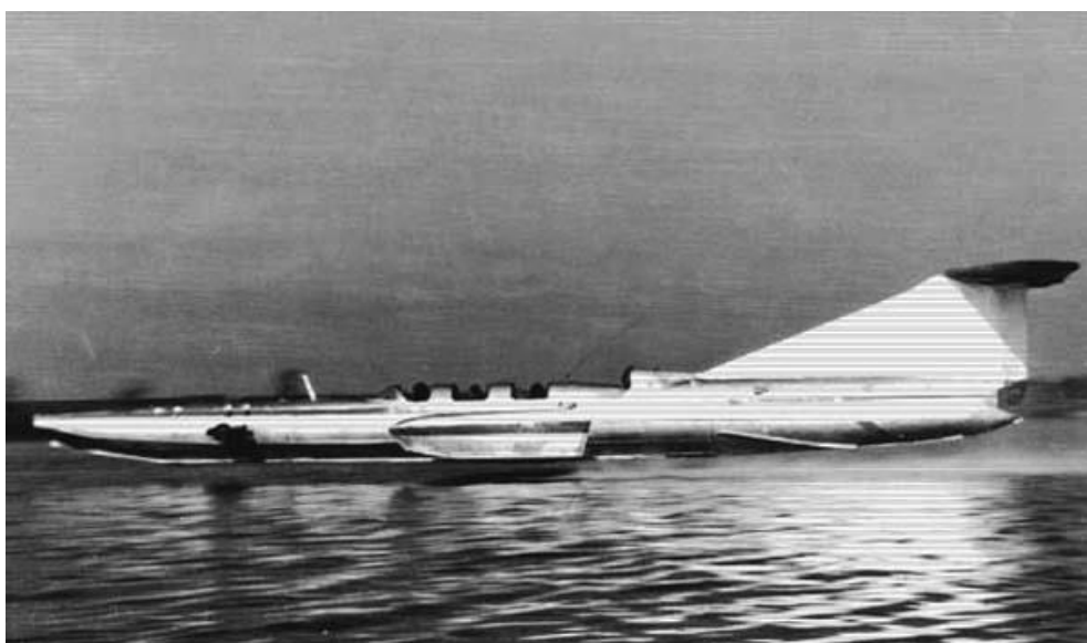
Рис. 2. Один из первых прототипов экранопланов СМ-1 [2]
