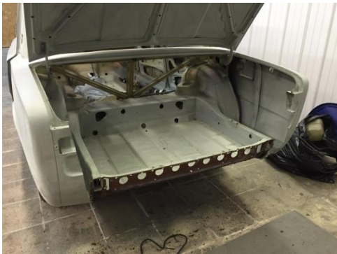
Рисунок 14 – Свердління по периметру - а. Процес демонтажу після свердління – б
