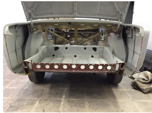
Рисунок 14 – Свердління по периметру - а. Процес демонтажу після свердління – б
