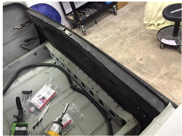
Рисунок 18 – Зачищається панель - а. Клей для панелей – б
