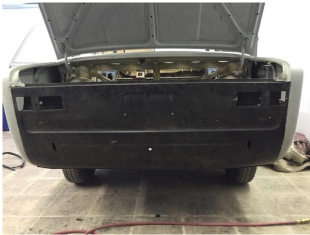
Рисунок 18 – Зачищається панель - а. Клей для панелей – б
