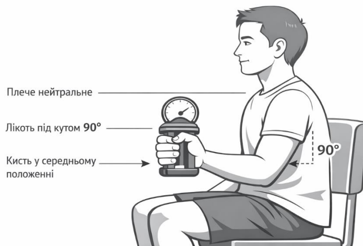
Рис. 2.1. Схема виконання тесту з визначення максимальної сили хвату кисті
