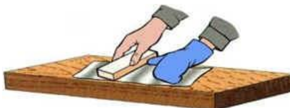
Рис. 4. Правка фольги на правильній плиті киянкою
