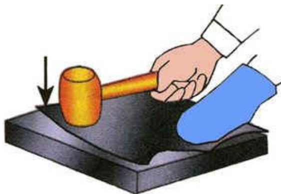
Рис. 3 Правка тонколистового металла
