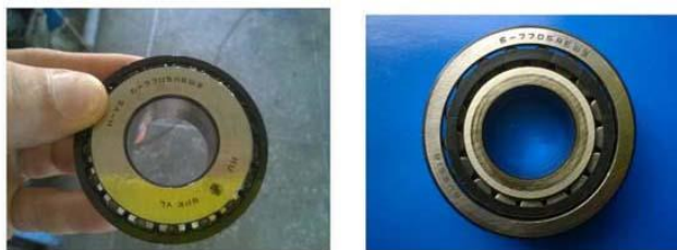
Рис. 3. Підшипник 6-7705АЕШЗ. (а); Знятий підшипник (б)
