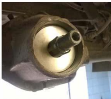
Рис. 7. Втулка, підшипник (а), шайба та встановлений сальник на герметику (на фото його закриває шайба) (б)
