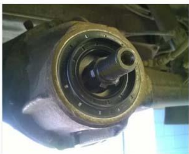
Рис. 8. Майже відремontований вузол автомобіля (втулка, підшипник, шайба та сальник на герметик) (а). Затягування гайки хвостовика (б)
