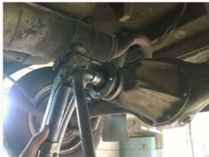
Рис. 8. Майже відремontований вузол автомобіля (втулка, підшипник, шайба та сальник на герметик) (а). Затягування гайки хвостовика (б)
