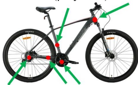
Рисунок 2 – Схема можливих місць розташування серійного номеру велосипеда
