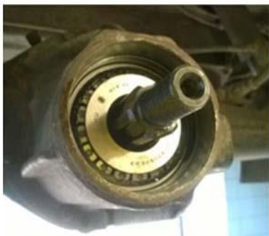
Рис. 7. Втулка, підшипник (а), шайба та встановлений сальник на герметику (на фото його закриває шайба) (б)
