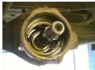
Рис. 2. Знімання зовнішньої обойми підшипника (а); Редуктор без підшипника (б).
