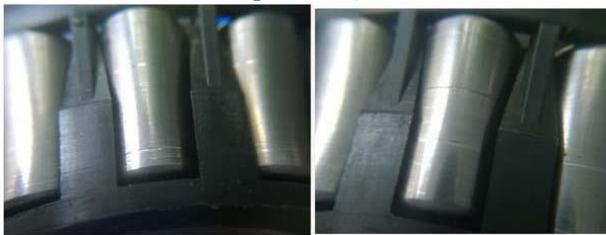
Рис. 4. Подряпини на роликах (а); Знятий підшипник (б)
