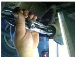
Рис. 2. Знімання зовнішньої обойми підшипника (а); Редуктор без підшипника (б).
