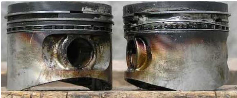
Рис. 2. Головки поршня разом з кільцями, що зазнавали експлуатації. Присутні ознаки «коксовання» [7]
