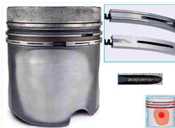
Рис. 3. Головки поршня разом з кільцями, що зазнавали експлуатації та мають «зношування» [9]
