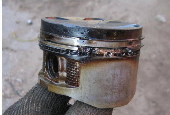
Рис. 1. Головка поршня разом з кільцями, що зазнавали експлуатації [7]
