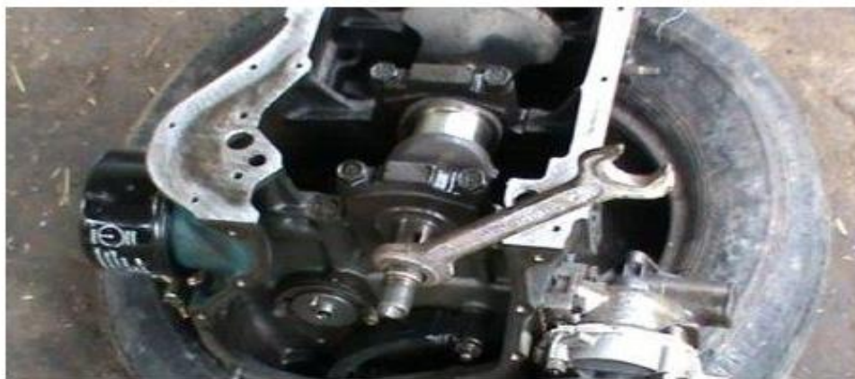
Рисунок 8 – Так ключем можна повертати колінчастий вал на двигуні ВАЗ [7]
