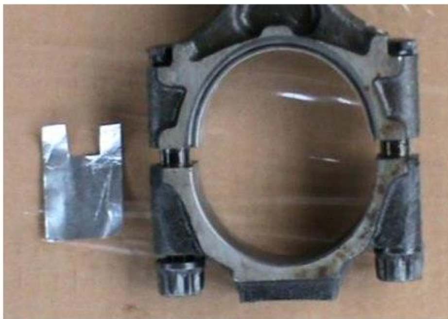
Рисунок 6 – Вид фольги перед підкладкою між «подушками» [7]
