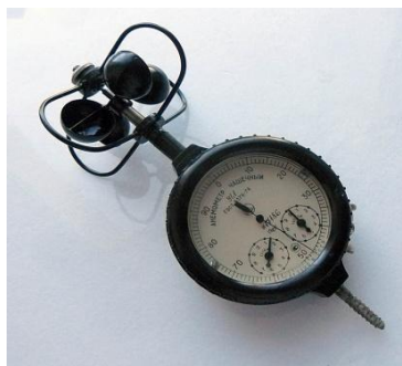
Рис. 2. Метеорологічні прилади для вимірювання напрямку та швидкості вітру (зліва направо: анемометр чашковий, windsack (вітровказівник), флюгер), (складено автором).
