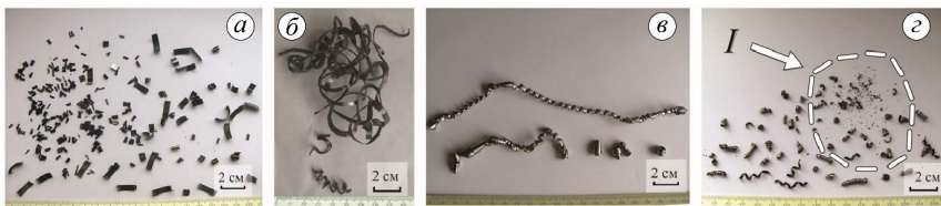
Рис. 1. Стружки утворенні при точінні сталі 38ХН3МФА на сухо (200 об/хв) після: у стані поставки – а; ковки (технологічна операція - обдирка) – б; термообробки – в; тривалої експлуатації в у водневовмісному середовищі – з (орієнта «кришка» стружка - І).
