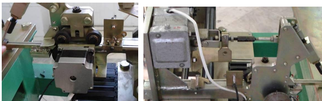
Рисунок 4 – Модуль подачи, контроля и обрезки стержня
