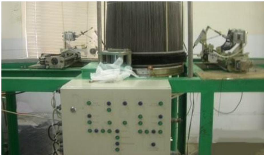
Рисунок 6 – Диаметральное расположение подающих модулей на установке
