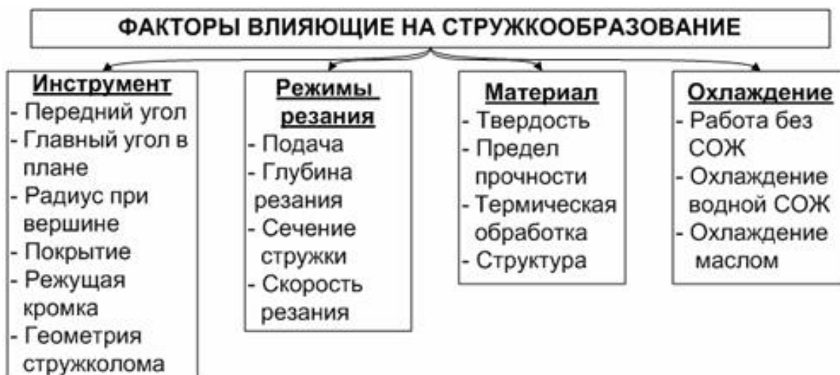
Рисунок 5 – Факторы, влияющие на стружкообразование [28]
