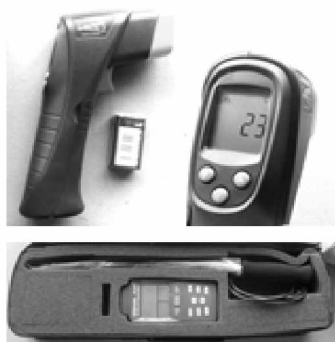
Рис. 4. Вимірвальна апаратура. Пірометр, анемометр
