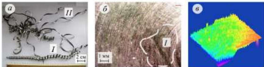
Рис. 1. Продукти різання (стружка) з високоазотної сталі –а; поверхня різання – б; комп'ютерна візуалізація поверхні різання – в.
