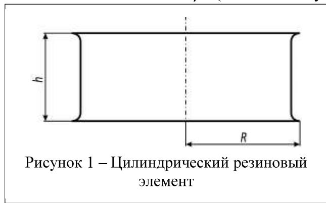
Рисунок 1 – Цилиндрический резиновый элемент
