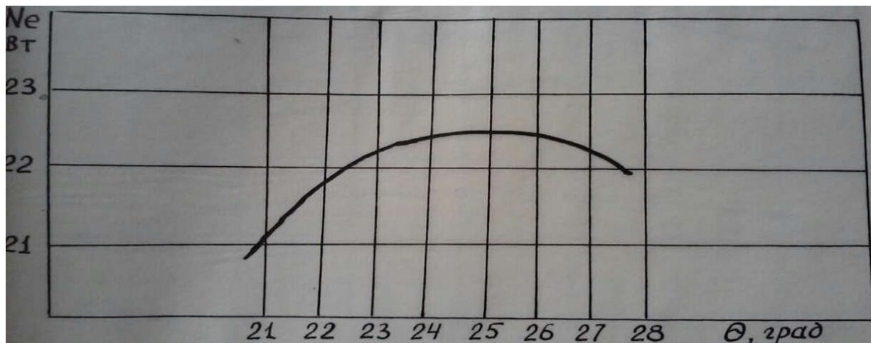
Рис.2. Детонаційна характеристика двигуна на метанолі ( \epsilon=12,8 ; n=3000 \text{ хв}^{-1} ; — t_{\text{п}}=25^{\circ}\text{C} )
