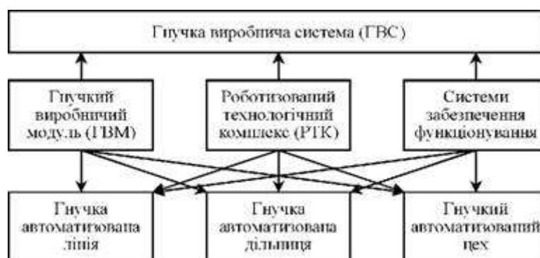
Рис. 5.5. Структура гнучкої виробничої системи
