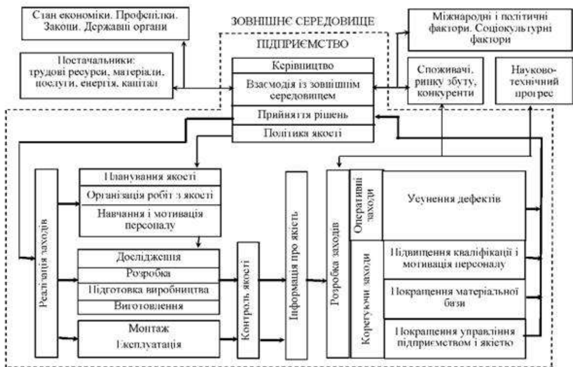
Рис. 8.2. Функціональна схема управління якістю продукції («петля якості»)
