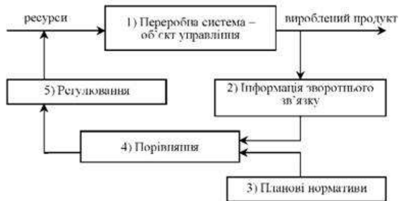
Рис.6.11. Узагальнююча модель процесу оперативного управління (виробництво)
