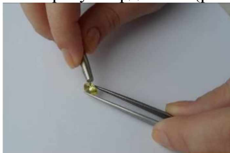
Рисунок 3 – Визначення твердості об'єкта дослідження
