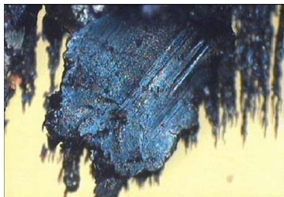
Рис. 7. Частица образовавшаяся при износе шестерен и зубчатых колес в редукторе
