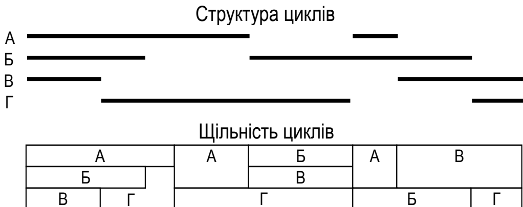
Рис. 6.8. Варіювання структурою циклів та їхньою щільністю для забезпечення пропорційного завантаження обладнання або підрозділів
