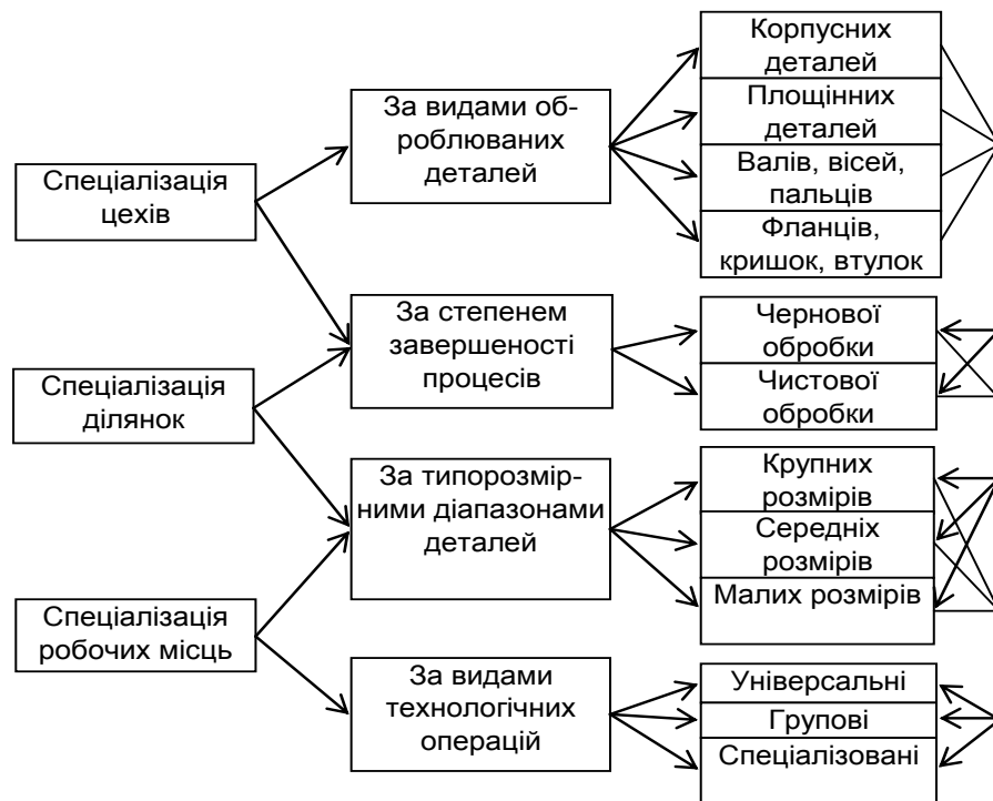
Рис. 8.2. Комбінація видів спеціалізації цехів, ділянок і робочих місць механічної обробки
