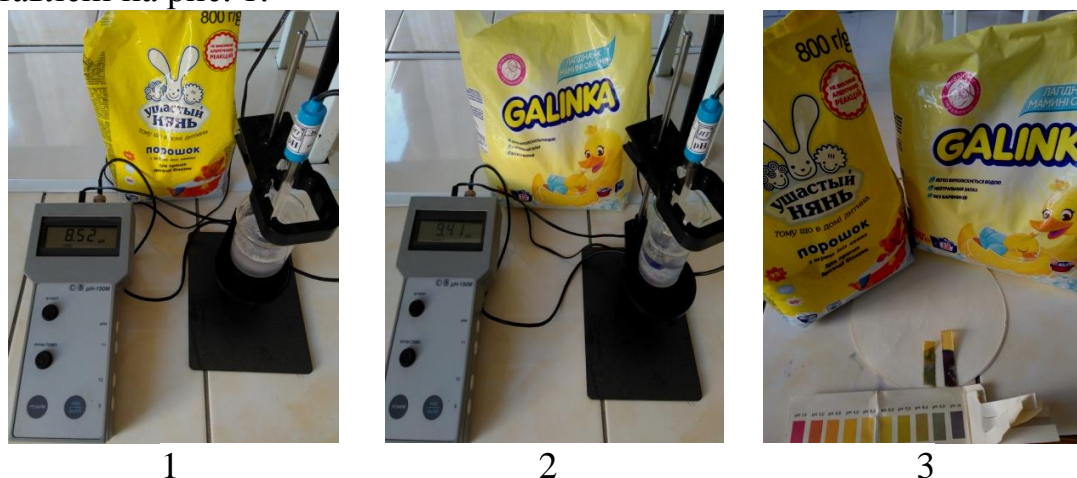
Рисунок 1 – Результати дослідження показника концентрації водневих іонів за допомогою: 1, 2 – рН-метра, 3 – індикаторного паперу
